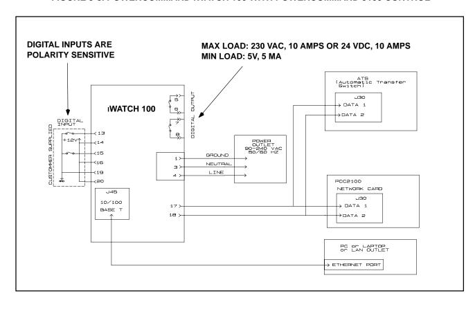
FIGURE 3-9. POWERCOMMAND IWATCH 100 WITH POWERCOMMAND 2100 CONTROL
