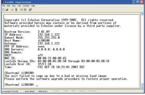
FIGURE 4-7. I.LON 100 IN THE BOOTROM MODE AFTER FORMATTING
