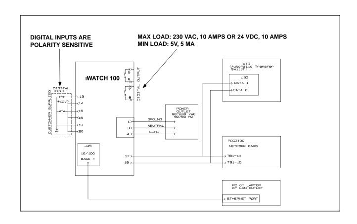
FIGURE 3-8. POWERCOMMAND IWATCH 100 WITH POWERCOMMAND 3100 CONTROL
