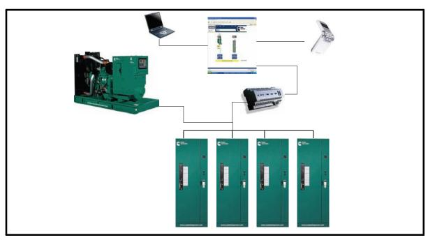
FIGURE 1-1. THE POWERCOMMAND IWATCH 100 MONITORING SYSTEM
